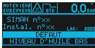
Pour plus de détails sur l'événement en cours, effectuer un appui court sur la roue codeuse.
