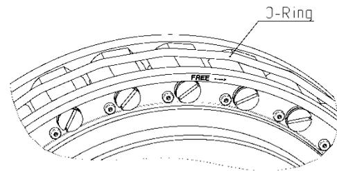
Abb. 5: Klemmkörper „abgehoben“
