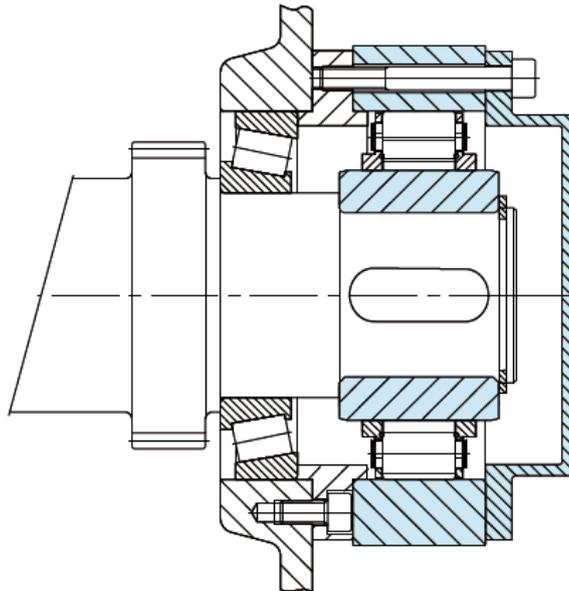
Abbildung 6: Einbaubeispiel, Montage auf dem Wellenende
