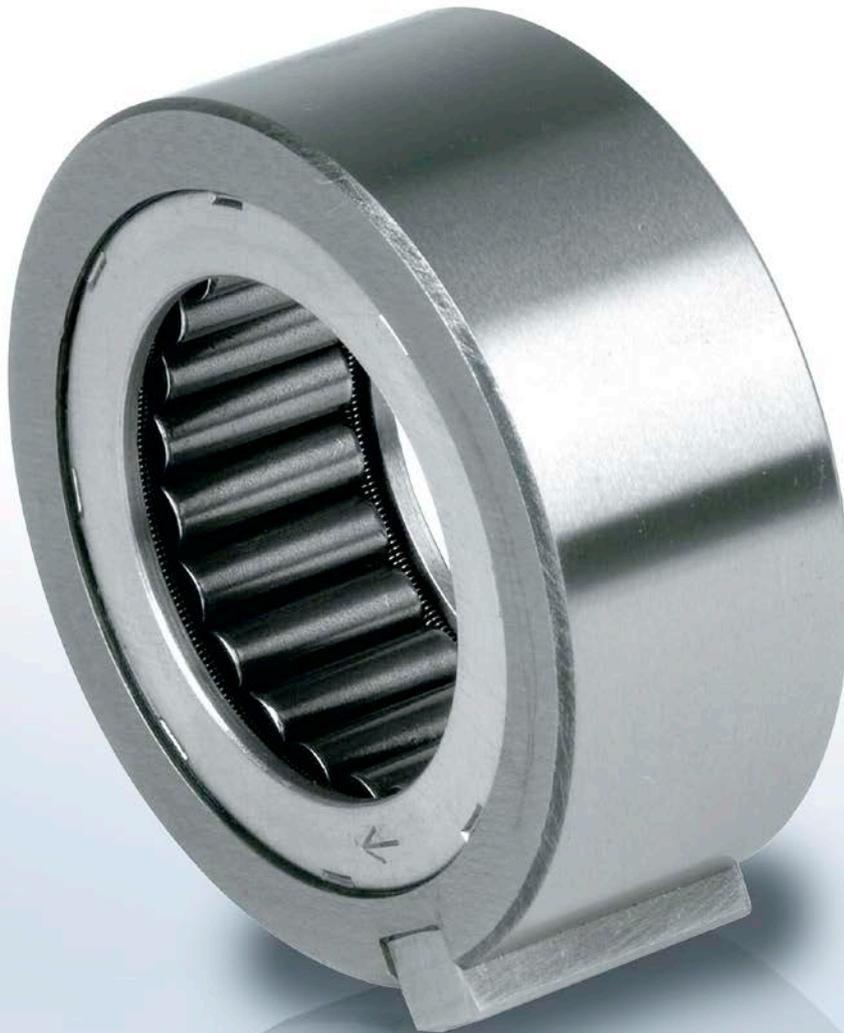
Die Bauart S200 ist ein ungelagerter Klemmkörper-freilauf. Die Klemmkörper laufen direkt auf der vom Anwender angebrachten Welle. Lagerung, Schmierung und Abdichtung müssen bei der Maschinenkonstruktion vorgesehen werden.
