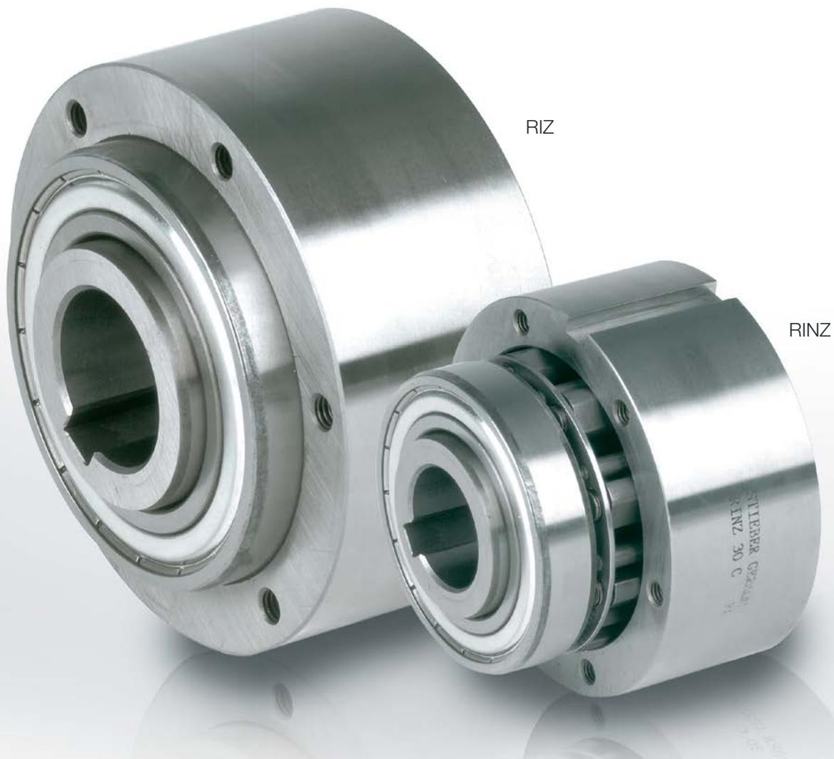
Die Bauarten RIZ und RINZ sind fliehkraftabhebende Klemmkörperfreiläufe bei drehendem Innenring. Beim Einsatz als Rücklaufsperre oder Überholkupplung muss der Innenring die Überholbewegung ausführen. Diese Freiläufe sind mit zwei fettgeschmierten und ZZ-abgedichteten Lagern der Reihe 60.. gelagert.
