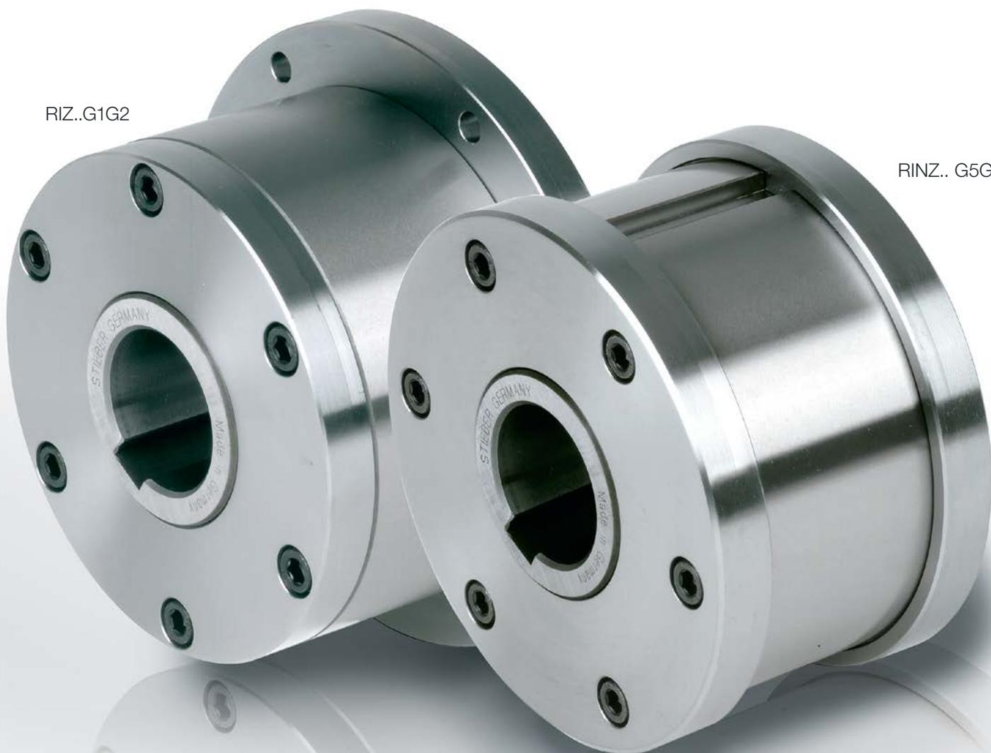
Die Bauarten RIZ..G1G2/G7G2 und RINZ..G5G5 sind fliehkraftabhebende Klemmkörperfreiläufe bei drehendem Innenring. Beim Einsatz als Rücklaufsperrung oder Überholkupplung muss der Innenring die Überholbewegung ausführen.
