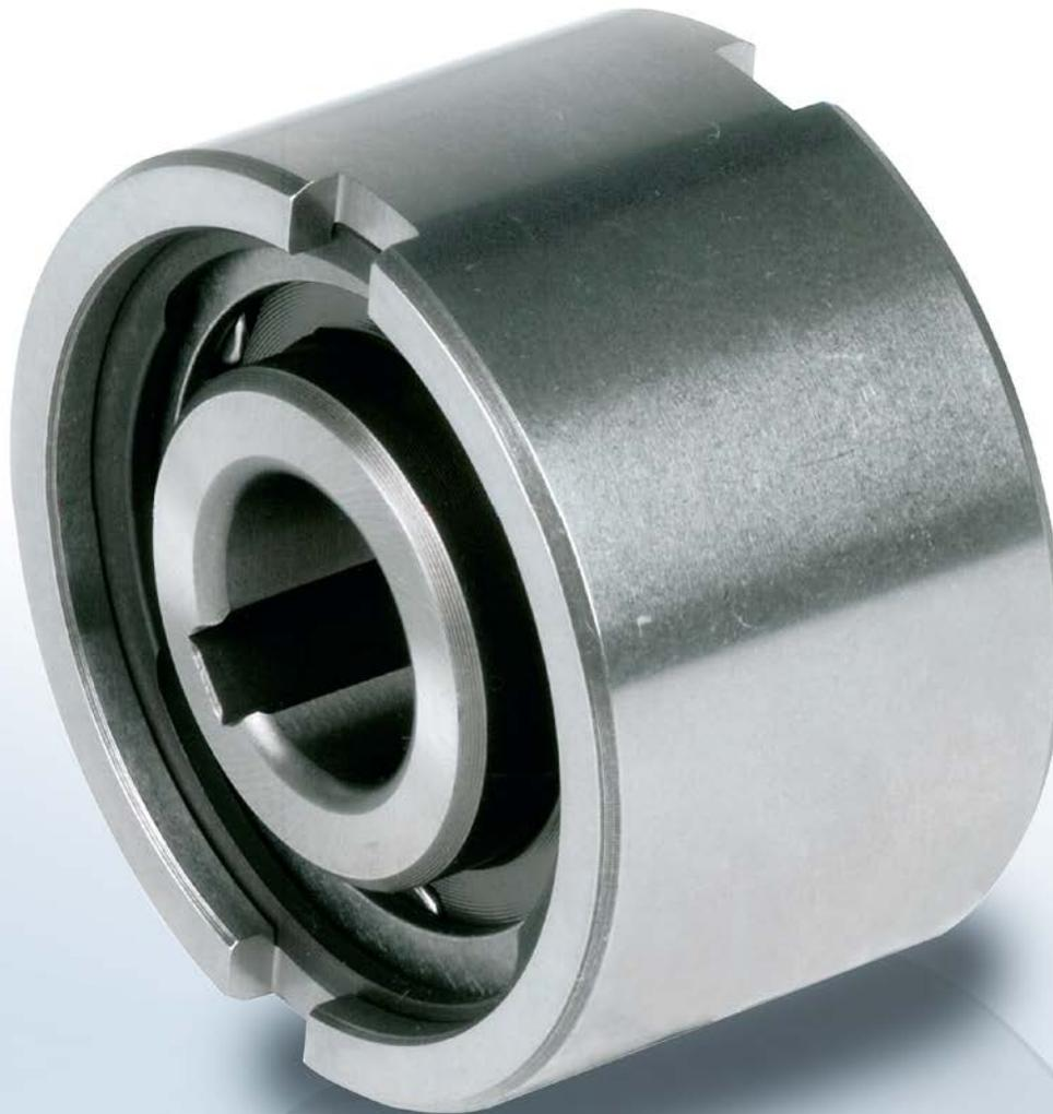
Die Bauart NF ist ein ungelagerter Rollenfreilauf. Auf eine einwandfreie Lagerung, Schmierung und Abdichtung des Freilaufes ist zu achten.
